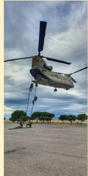
y operatividad de los nuevos helicópteros debido a la mejora de los sistemas de estabilización y la disminución del tiempo en el montaje de los sistemas FRIES. Además, se pudo comprobar un aumento en la rapidez y agilidad de la realización de los procedimientos debido a un incremento en la velocidad máxima de vuelo durante el SPIERIG y a la posibilidad de tener un operador en cada maroma bajando simultáneamente durante el FASTROPE.
