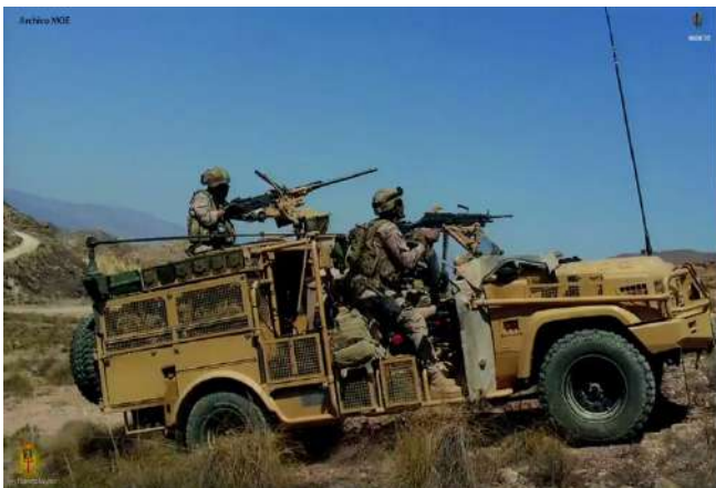
Los vehículos de los especialistas en movilidad llevan depósitos de gran capacidad, mayor elasticidad para los baches y medios sofisticados de navegación
